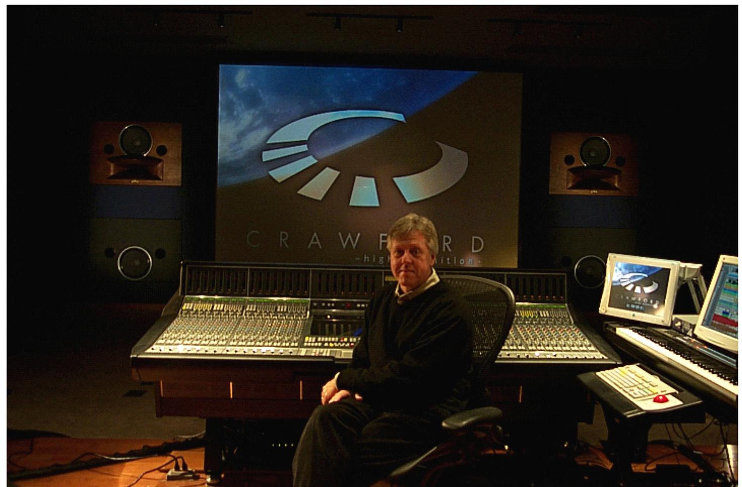
在 Crawford Audio - A Studio 内，前方左右声道设置 REY AUDIO 鉴听喇叭 ( Kinoshita Monitor RM - 5BC )，中置喇叭 ( 同 RM - 5BC ) 设置在银幕的后面，使用 NHK 技术研究所开发的可透音层银幕，实现音响与映像理想的结合方式。
